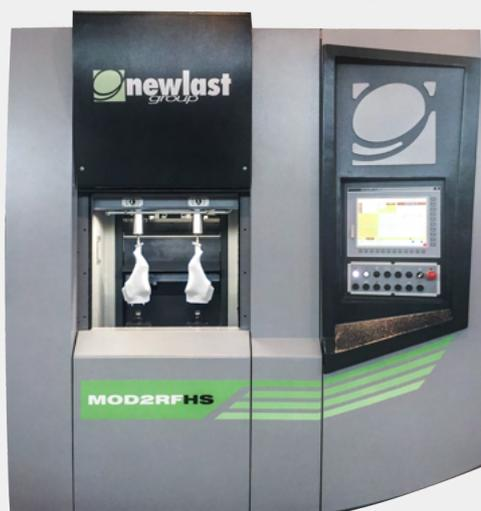
La Macchina esegue, in un unico ciclo di lavoro, la lavorazione di sgrossatura e di finitura di un paio di forme in plastica o legno.
