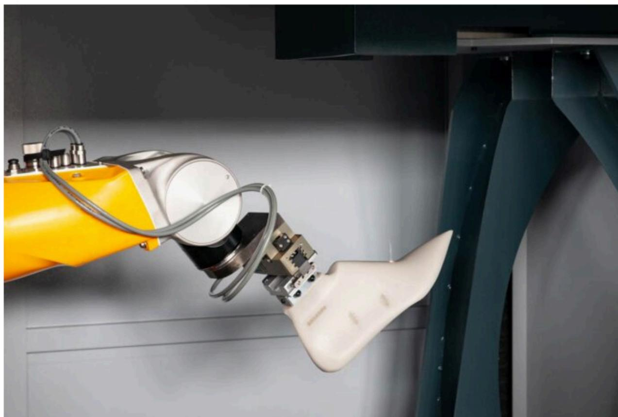
**Newlast** è un'azienda italiana specializzata nella progettazione e produzione di sistemi altamente tecnologici per la produzione di forme per calzature. Dopo il successo della tecnologia SDF per la tornitura della forma e anni di studio e sviluppi software e hardware, Newlast oggi è in grado di dare libertà totale al calzaturificio per tutto ciò che concerne la procedura di **marcatura della forma**, velocizzando e migliorando notevolmente il processo di **produzione\montaggio delle scarpe**.
