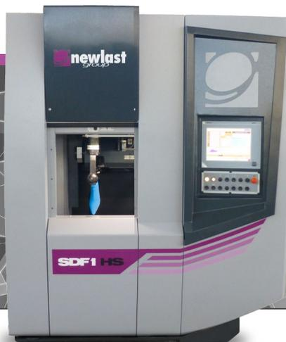
**■ ■** SDF1 HS è la macchina di ultima generazione che consente di realizzare, in un unico ciclo di lavoro, il modello destro o sinistro della forma, partendo dal blocco grossato.
