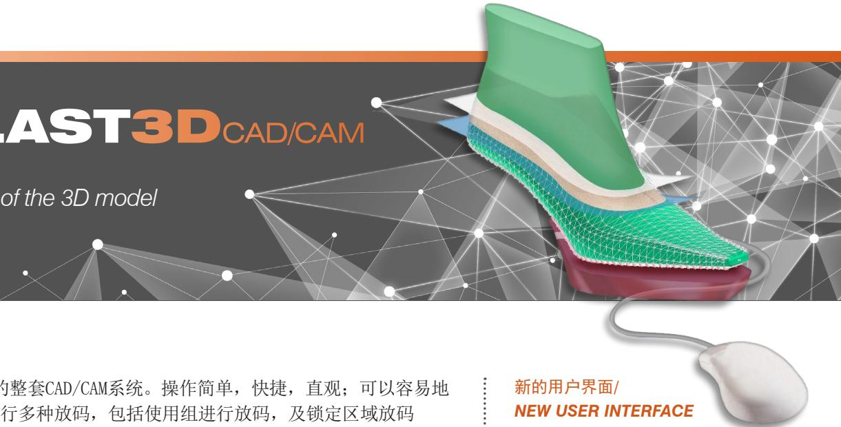
3D鞋楦设计及放码的整套CAD/CAM系统。操作简单，快捷，直观；可以容易地输入鞋楦，修改鞋楦，进行多种放码，包括使用组进行放码，及锁定区域放码。除了包含之前版本（EASYLAST3D 2.6版本）的特色，还增加了组合配件到鞋楦的功能，比如把3D大底或者水台组合到鞋楦上面，生成机器可以铣削的文件（FRA），从而使得软件功能更加完善。
