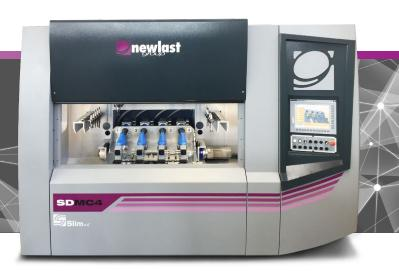
SDMC4是一个8轴工作中心,用于在鞋楦上进行特殊的钻孔和铣削周期。主轴在X、Y和Z轴上移动,而主轴则处于倾斜和旋转状态。该操作是在2对粗加工中进行的,(并最终铰接)持续,夹紧通过脚趾和脚跟支撑完成,每个循环一次在一个最后完成。这台机器装有10个工具。
