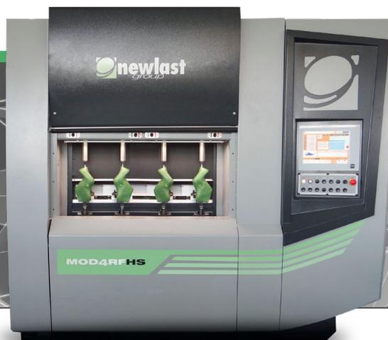
La macchina esegue, in un unico ciclo di lavoro, la lavorazione di sgrossatura e di finitura di due paia di forme in plastica o legno.
